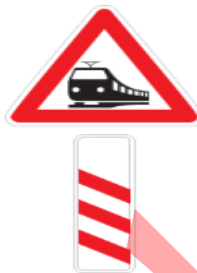
ح: تقاطع جاده و راه آهن بدون راه‌بند نصب در ۳۰۰ متری
