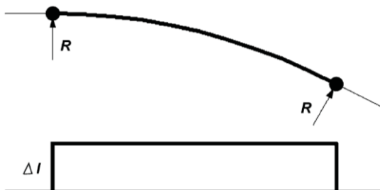
شکل ۵-۷ ترکیب قوس دایره و مسیر مستقیم بدون بر بلندی (نمونه یک انشعاب استاندارد)
